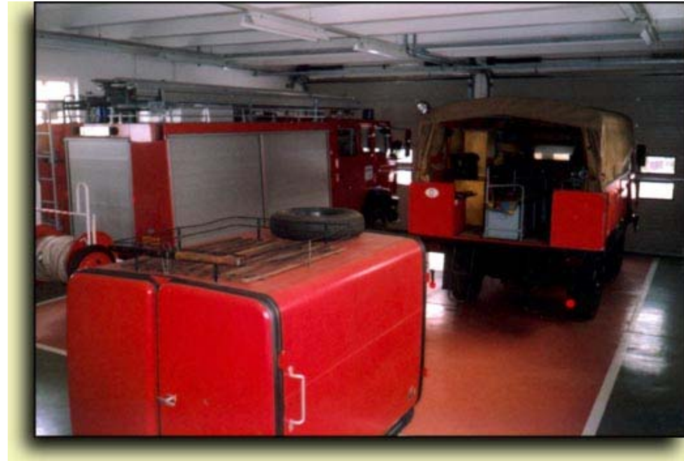
Schlauchtransportanhänger (STA) mit 640 Metern B-Schlauch für Wasserversorgung von Fluss/Teich zum Brandobjekt (LF 16/12)
